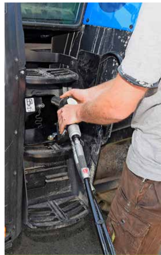
Le plein est aussi rapide qu'avec du diesel. Le réservoir peut contenir 30 kg de gaz.
